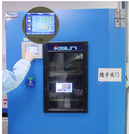
图 7-3 高低温老化测试图
