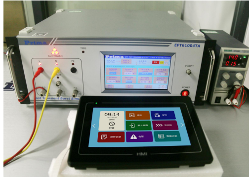
图 7-4 群脉冲测试图
